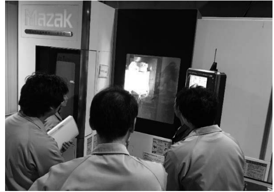
図7 複合加工機による実加工（4軸加工）
