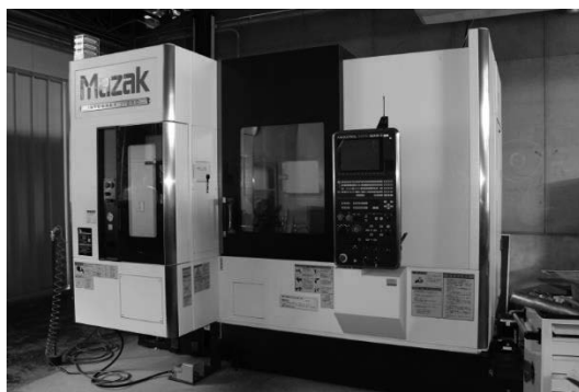
図1 複合加工機 (INTEGREX j-200)
